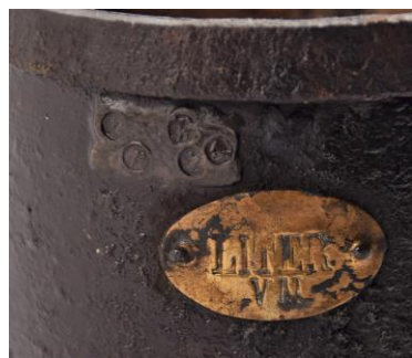
Afbeelding 35: Koperen maatplaatje met tin/lood plaatje voorzien van ijkmerken.
