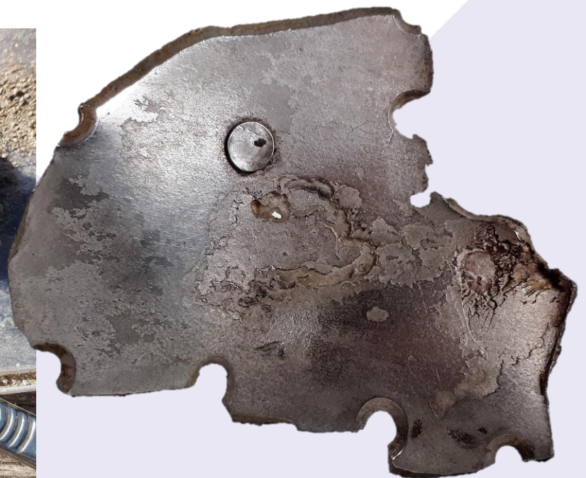
Geconserveerd stuk met nog een klinknagel en klinknagelgaten.
